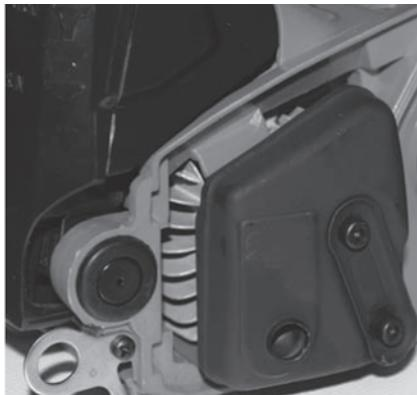
Грязные ребра цилиндра двигателя могут стать причиной его перегрева и поломки. Регулярно очищайте от загрязнений ребра цилиндров кисточкой и/или сжатым воздухом.
