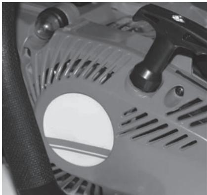
При загрязнении охлаждающих отверстий стартера продуктами распила и масляным шламом используйте для очистки кисточку и/или баллон со сжатым воздухом.
